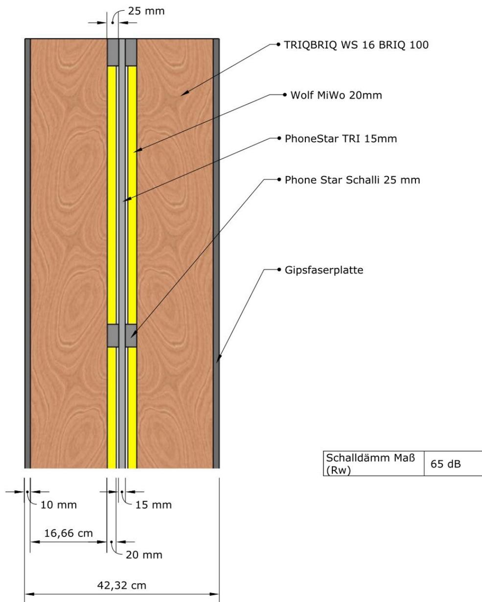
Horizontalschnitt Wandaufbau Doppelschaliges Wandsystem mit Wolf Bavaria „One Block“ mit Beplankung Gipsfaser- und Brandschutzplatten
