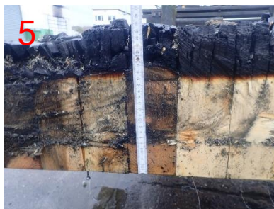
Bild 27: Restquerschnitt am Messpunkt 5 (ca. 200 mm)
