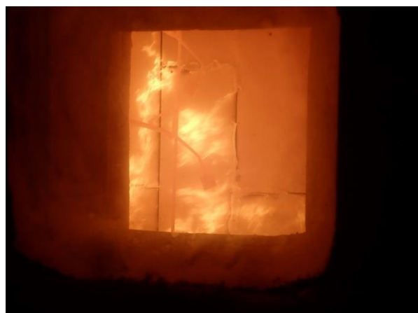
Bild 15: Prüfminute 62: Vertikal und horizontal eingebrachte Fugenmasse fast vollständig ausgefallen. Alle Fugenübergänge leicht geöffnet mit partiellen Eigenbrand.
