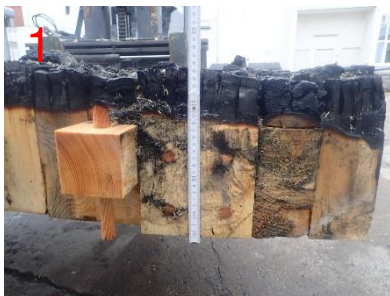
Bild 23: Restquerschnitt am Messpunkt 1 (ca. 190 mm)
