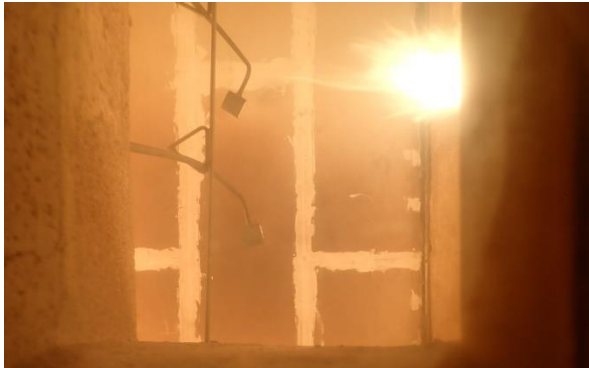
Bild 10: Prüfminute 1: Beginnende Schwarzfärbung der Oberfläche.
