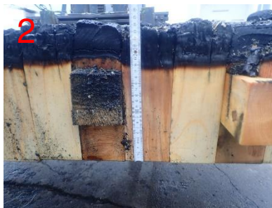
Bild 24: Restquerschnitt am Messpunkt 2 (ca. 175 mm)
