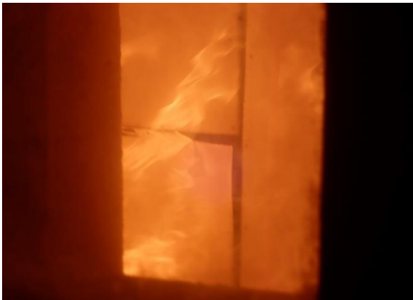
Bild 16: Prüfminute 80: Plattenlage öffnet sich und klappt partiell im Zentrum des Probekörpers auf.
