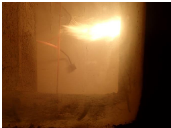
Bild 13: Prüfminute 32: Partielles ablösen und abfallen der vertikal und horizontal eingebrachten Fugenmasse. Plattenoberfläche fein verzettelt eingerissen.
