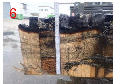
Bild 28: Restquerschnitt am Messpunkt 6 (ca. 180 mm)
