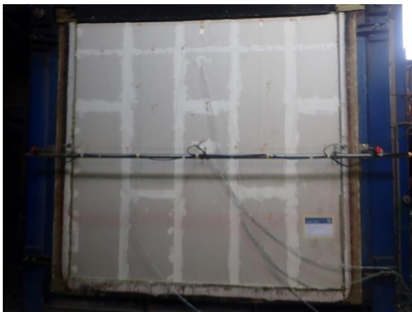
Bild 9: Blick auf die feuerabgewandte Wandseite nach der Montage der Bekleidung/ Beplankung und der nachträglich erzeugten horizontalen Fuge.
