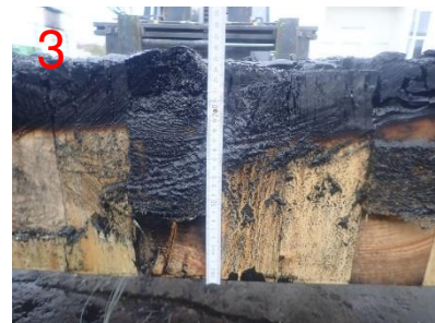
Bild 25: Restquerschnitt am Messpunkt 3 (ca. 180 mm)
