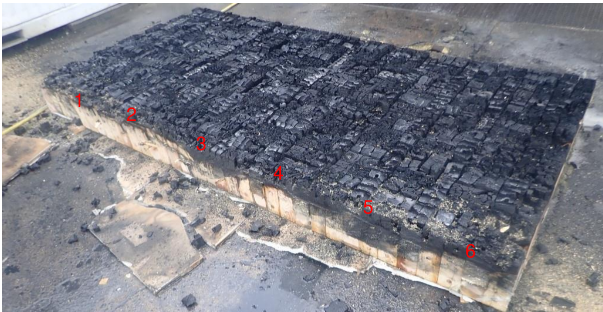
Bild 22: Blick auf den abgelöschten Probekörper; Reste der Holzkohleschicht entfernt; zur Dokumentation des Restquerschnittes wurde der Probekörper 1500 mm von der Oberkante aufgetrennt.
