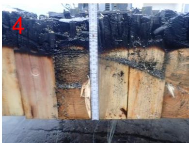
Bild 26: Restquerschnitt am Messpunkt 4 (ca. 180 mm)
