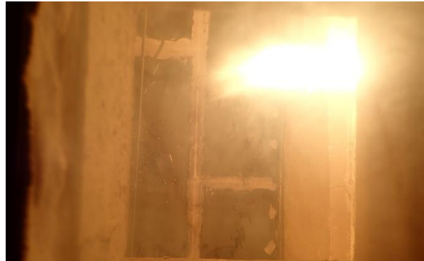
Bild 11: Prüfminute 3: Vollständige Schwarzfärbung der Oberfläche.
