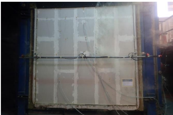
Bild 20: Prüfminute 131: Mäßiger Rauchaustritt über vertikalen Riss über der gesamten Plattenlänge am zweiten vertikalen Fugenübergang von rechts.
