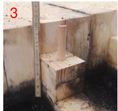
Bild 50: Restquerschnitt am Messpunkt 3 (ca. 185 mm)
