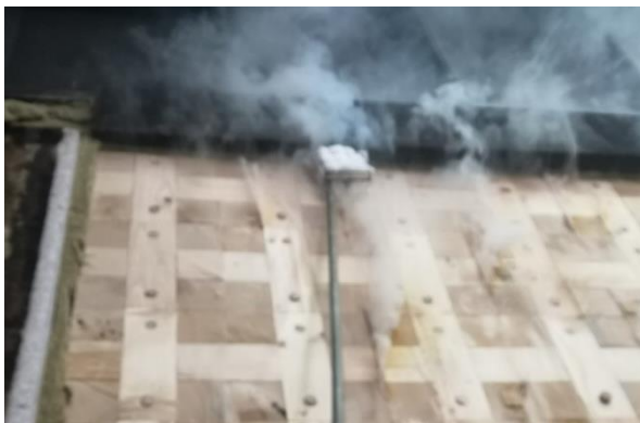
Bild 15: Prüfminute 31: 1. Wattbauschtest im Bereich der Oberflächenmessstelle OF 6, negativ.
