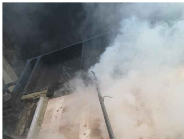
Bild 22: Prüfminute 44: 1. Messung mit Handthermoelement, keine Temperaturüberschreitung T \geq 180 K.
