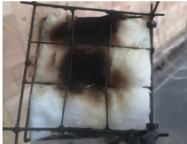
Bild 32: Prüfminute 60: 6. Wattbauschtest im Bereich der Oberflächenmessstelle OF 6, negativ.
