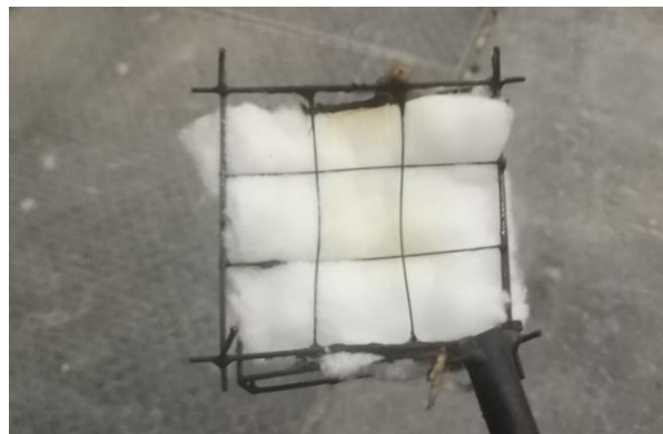
Bild 16: Prüfminute 31: 1. Wattbauschtest im Bereich der Oberflächenmessstelle OF 6, negativ.
