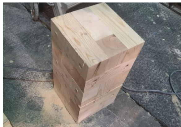
Bild 6: Blick auf einen BRIQ50 nach dem abtrennen der Zapfen und vor dem aufstecken auf die Wandkonstruktion.
