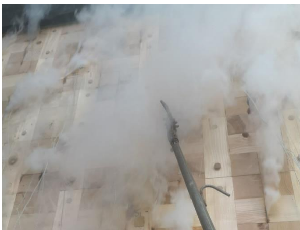
Bild 21: Prüfminute 44: 1. Messung mit Handthermoelement, keine Temperaturüberschreitung T \geq 180 K.
