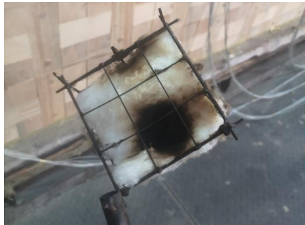
Bild 42: Prüfminute 71: 9. Wattbauschtest im Bereich der Oberflächenmessstelle OF 18, negativ.
