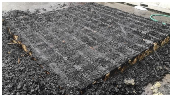
Bild 46: Ende der Feuerwiderstandsprüfung
