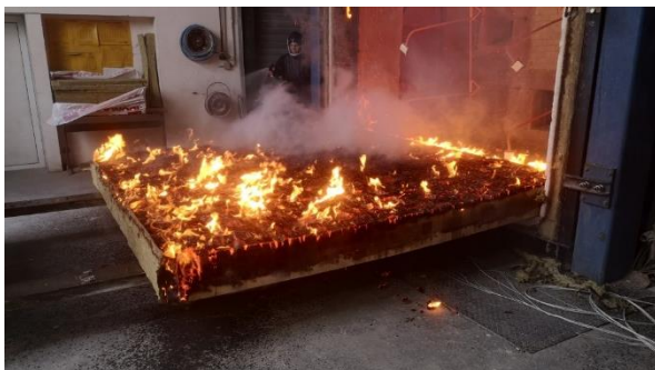
Bild 45: Ende der Feuerwiderstandsprüfung
