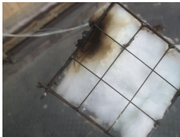
Bild 40: Prüfminute 70: 8. Wattbauschtest im Bereich der Oberflächenmessstelle OF 18, negativ.
