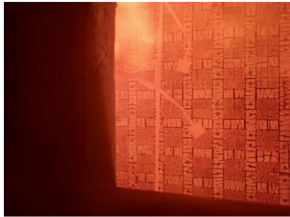
Bild 18: Prüfminute 33: Kohlsegmente der Kantholz-Strinflächen fallen partiell aus der Prüfoberfläche ab. Fugenübergänge am Vollholzstein sowie von Vollholzstein zu Vollholzstein teilweise stark eingebrannt.
