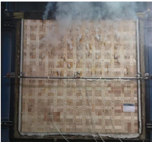
Bild 27: Prüfminute 54: Zunehmende partielle Schwarzfärbung der äußeren Fugenübergänge.
