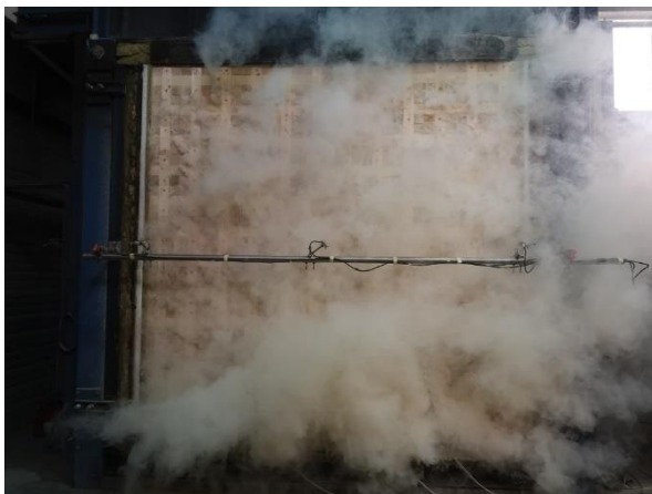
Bild 13: Prüfminute 8: Starker, dauerhafter Rauchaustritt aus der gesamten Oberfläche.
