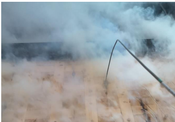
Bild 37: Prüfminute 69: 3. Anwendung der Spaltlehre (6 mm), kann zwischen den Oberflächenmessstellen OF 1 und OF 8 eingesteckt jedoch nicht geführt werden.
