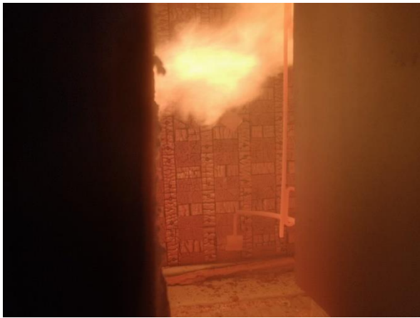
Bild 17: Prüfminute 33: Kohlsegmente der Kantholz-Strinflächen fallen partiell aus der Prüfoberfläche ab. Fugenübergänge am Vollholzstein sowie von Vollholzstein zu Vollholzstein teilweise stark eingebrannt.
