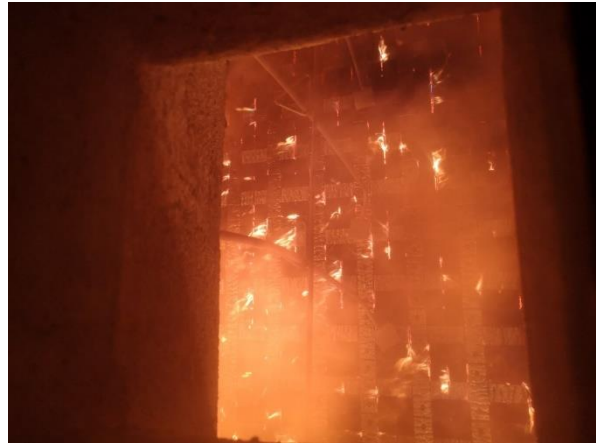
Bild 12: Prüfminute 7: Verstärktes ausbrennen der offenen Fugenübergänge von Vollholzstein zu Vollholzstein in Verbindung mit partiellen Eigenbrand.
