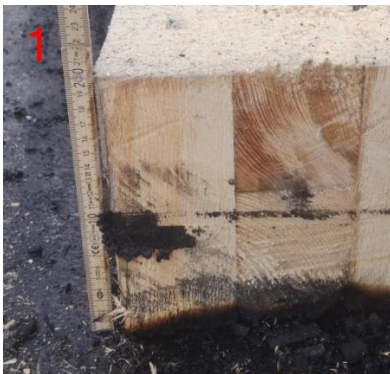
Bild 48: Restquerschnitt am Messpunkt 1 (ca. 200 mm)
