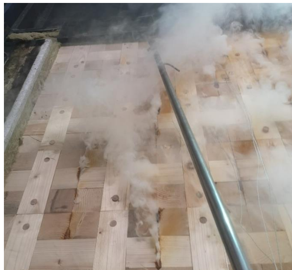
Bild 28: Prüfminute 55: 2. Messung mit Handthermoelement, Temperaturüberschreitung T \geq 180 \text{ K} .
