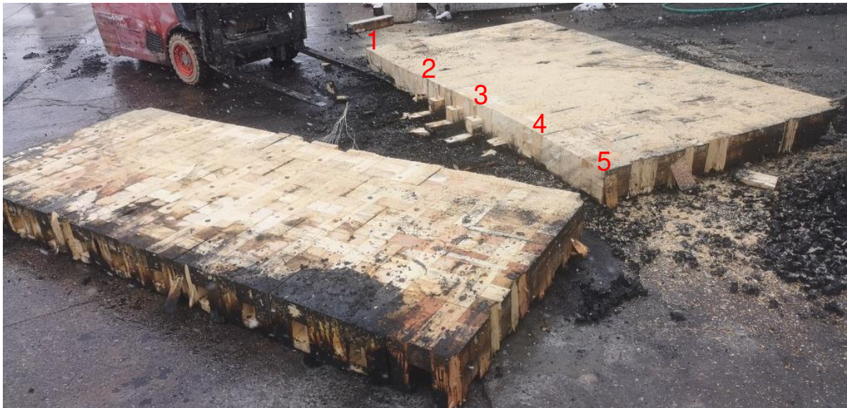
Bild 47: Blick auf den abgelöschten Probekörper; Reste der Holzkohleschicht entfernt; zur Dokumentation des Restquerschnittes wurde der Probekörper 1500 mm von der Oberkante aufgetrennt.
