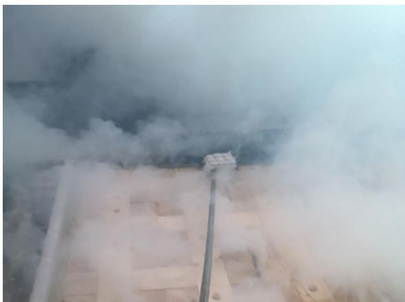
Bild 33: Prüfminute 65: 7. Wattbauschtest im Bereich der Oberflächenmessstelle OF 6, negativ.
