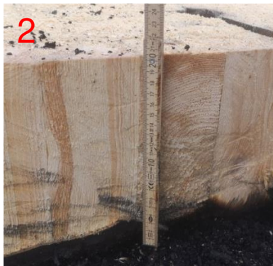
Bild 49: Restquerschnitt am Messpunkt 2 (ca. 175 mm)
