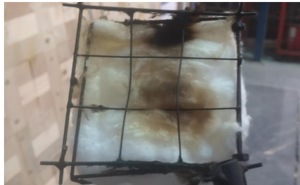
Bild 26: Prüfminute 52: 4. Wattbauschtest im Bereich der Oberflächenmessstelle OF 6, negativ.
