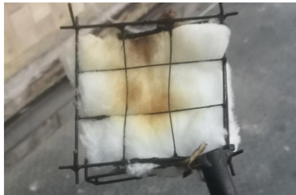
Bild 20: Prüfminute 41: 2. Wattbauschtest im Bereich der Oberflächenmessstelle OF 6, negativ.
