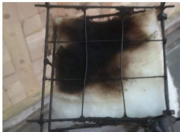
Bild 34: Prüfminute 65: 7. Wattbauschtest im Bereich der Oberflächenmessstelle OF 6, negativ.
