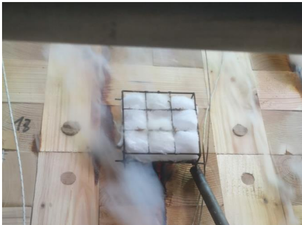
Bild 41: Prüfminute 71: 9. Wattbauschtest im Bereich der Oberflächenmessstelle OF 18, negativ.
