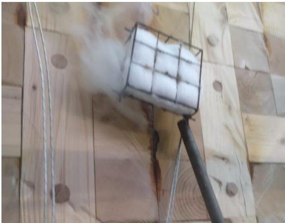
Bild 29: Prüfminute 58: 5. Wattbauschtest zwischen den Oberflächenmessstellen OF 3 und OF 18, negativ.
