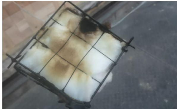
Bild 24: Prüfminute 50: 3. Wattbauschtest im Bereich der Oberflächenmessstelle OF 6, negativ.
