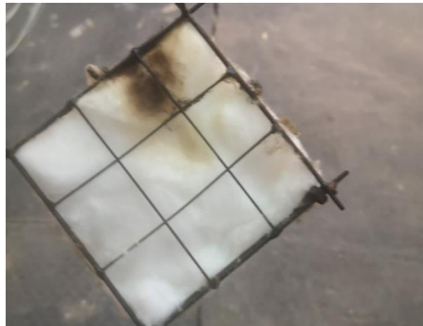
Bild 30: Prüfminute 58: 5. Wattbauschtest zwischen den Oberflächenmessstellen OF 3 und OF 18, negativ.
