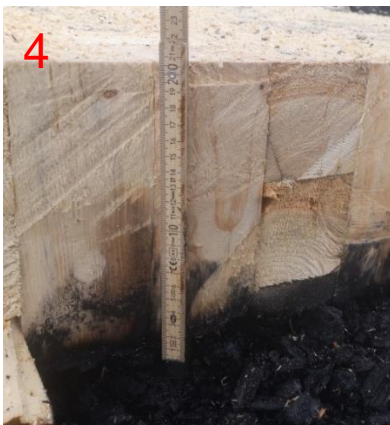
Bild 51: Restquerschnitt am Messpunkt 4 (ca. 200 mm)
