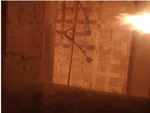
Bild 11: Start der Feuerwiderstandsprüfung. Beginn der Schwarzfärbung der Oberfläche.
