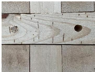
Bohrlöcher oder Fraßgänge in der Schnittholzoberfläche von 4 - 8 mm sind nicht zulässig (kleine Bohrlöcher bis 2 mm sind zulässig)
