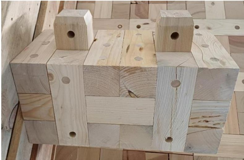
BRIQ nicht mehr verwendbar, weil Astlöcher größer als erlaubt, Schwind- und Blitzrisse vorhanden, Bohrlöcher und Fraßgänge größer als erlaubt
